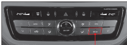
Schalter der hinteren Klimaanlage
